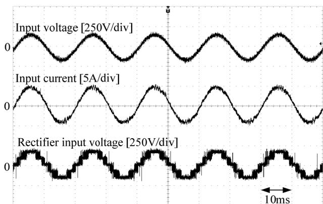
(b) Rectifier input voltage
