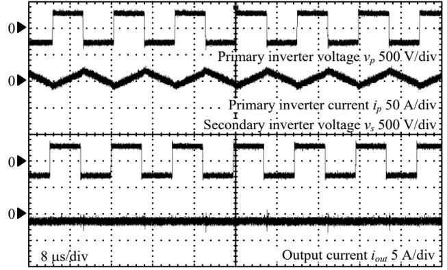
(d) Light load (300 W) with discharging operation.
