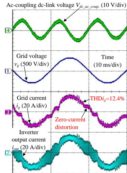
(d) Conventional CCM control,  $\%Z_L=0.5\%$ , light load of 2 kW
