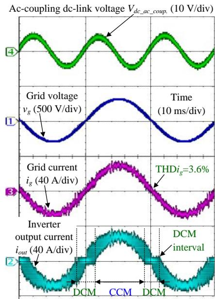
(d) Proposed CCM/DCM control,  $\%Z_L = 0.5\%$ , light load of 2 kW
